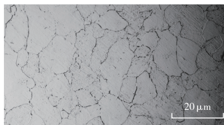
图2 旋压温度为1000℃,减薄率为10%条件下的变形显微组织 Fig.2 Deformation microstructure of Ti-22Al-25Nb alloy with 1000℃ and 10% reduction rate
